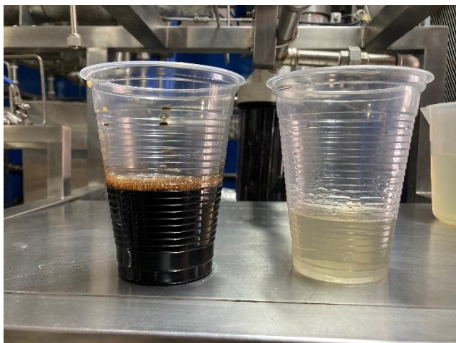
Tratamiento de AFFF (Formador de espuma) con PFAs. Izq. Residuo antes de tratamiento. Der. Efluente tratado.
