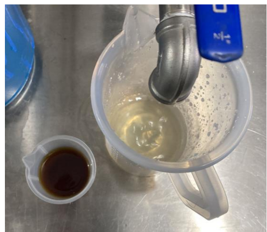
Tratamiento de sosa gastada. Izq. Residuo antes de tratamiento. Der. Efluente tratado.
